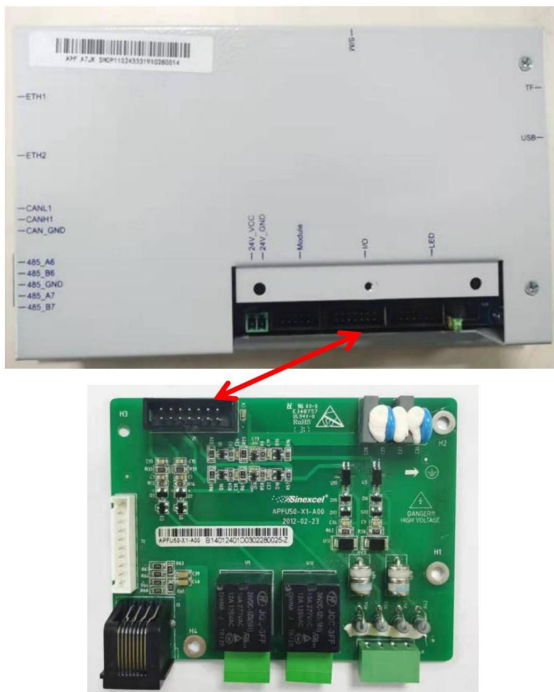
Figura A- 47 Conexión a HMI de 7 pulgadas
